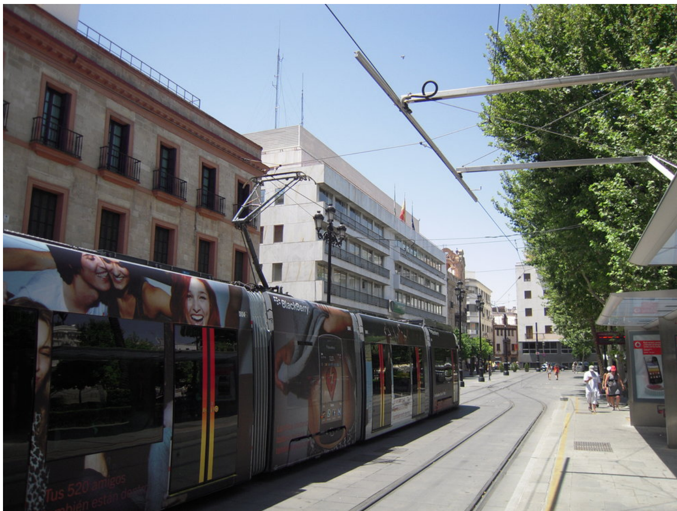
Nabíjecí rameno na konečné Plaza Nueva
