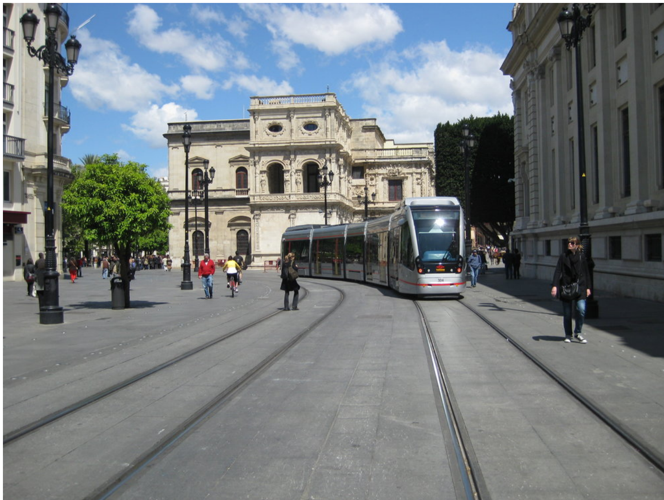
Někdo to rád bez troléjí... Tramvaj Urbos u katedrály po odstranění troléjí. (foto: Miguel Cano López-Luzzatti)
