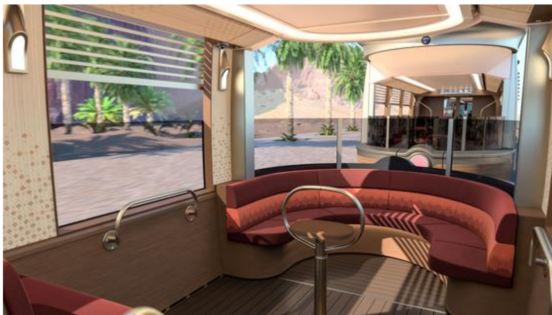
Půlkruhové posezení na zadním čele tramvaje Citadis B. (zdroj: Alstom)
