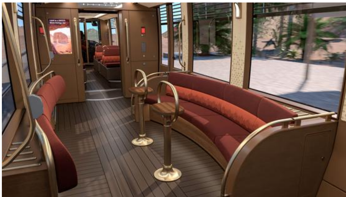
Uspořádání interiéru v neseném článku vozu Citadis B. (zdroj: Alstom)
