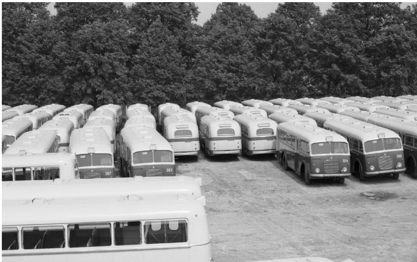
Autobusy Škoda 706 RO v Karose připravené na expedici do Turecka. na snímku lze dobře rozeznat provedení plochých zadních čel. (zdroj: archiv Iveco Czech Republic)
