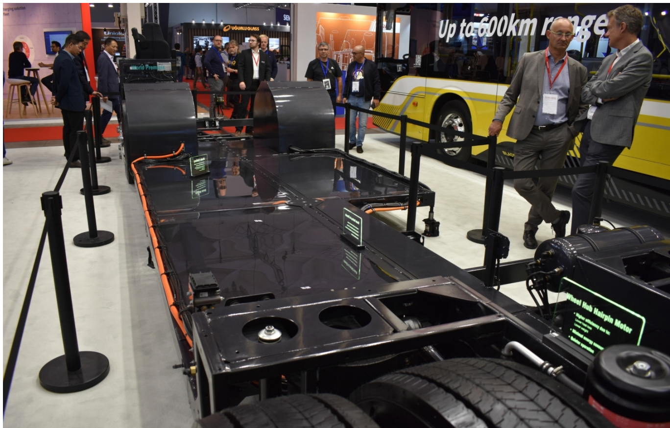
Podvozek BYD BC12 s integrovanými bateriemi v konstrukci rámu podvozku. (foto: Libor Hinčica)
