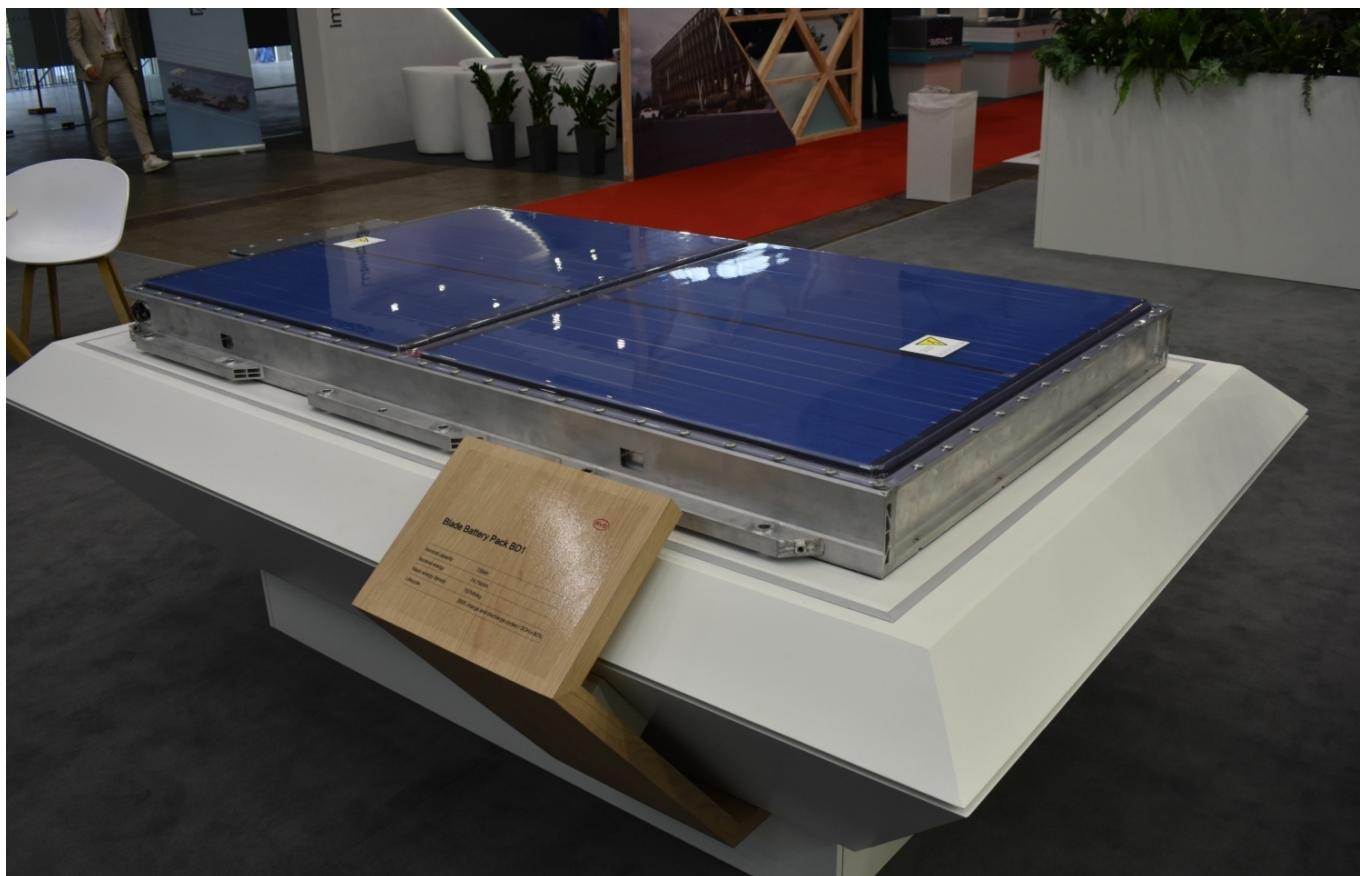
Samostatný bateriový pack o kapacitě elektrické energie 74,75 kWh. (foto: Libor Hinčica)
