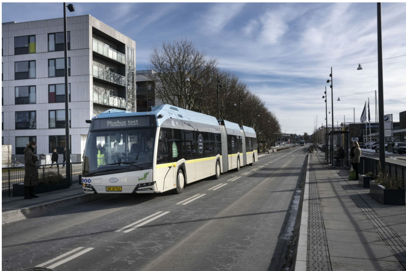
Testovací jízda tříčlánkového elektrobuse Urbino 24 electric v Aalborgu. (foto: Lars Horn, zdroj: Plusbus)
