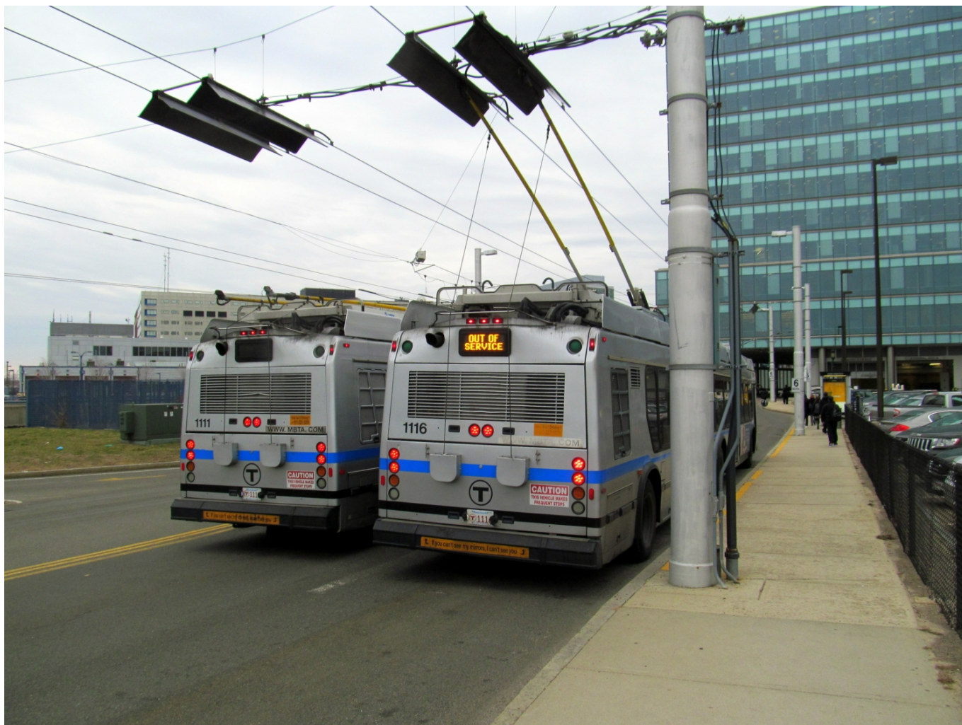
Natrolejování trolejbusů/duobusů ve stanici Silver Line Way (zdroj: Wikipedia.org)
