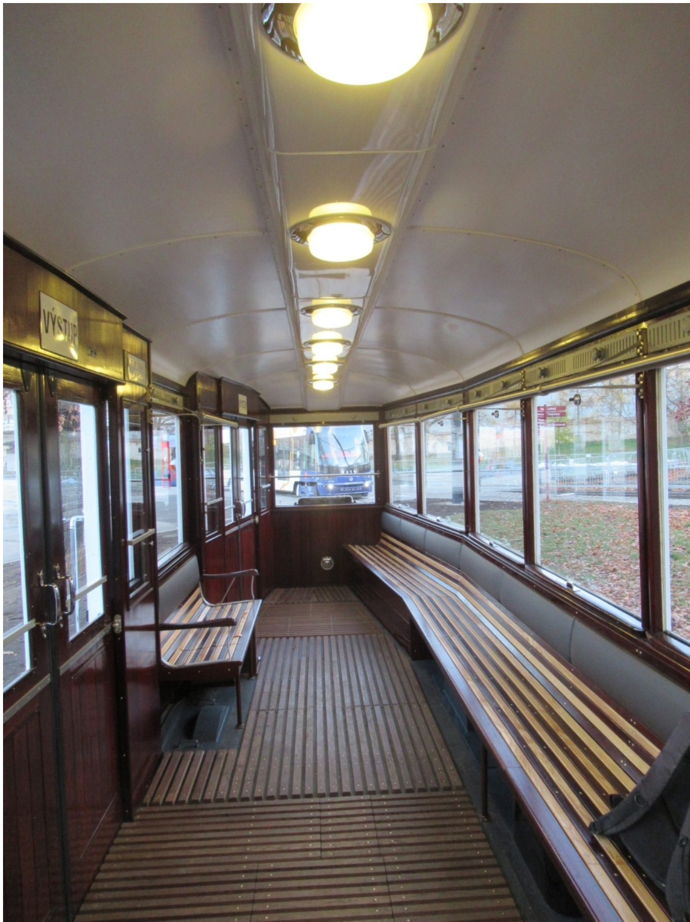
Pohled do rekonstruovaného interiéru, v němž však oproti historické přesnosti absentuje místo pro průvodčího. (foto: Luděk Vidím)
