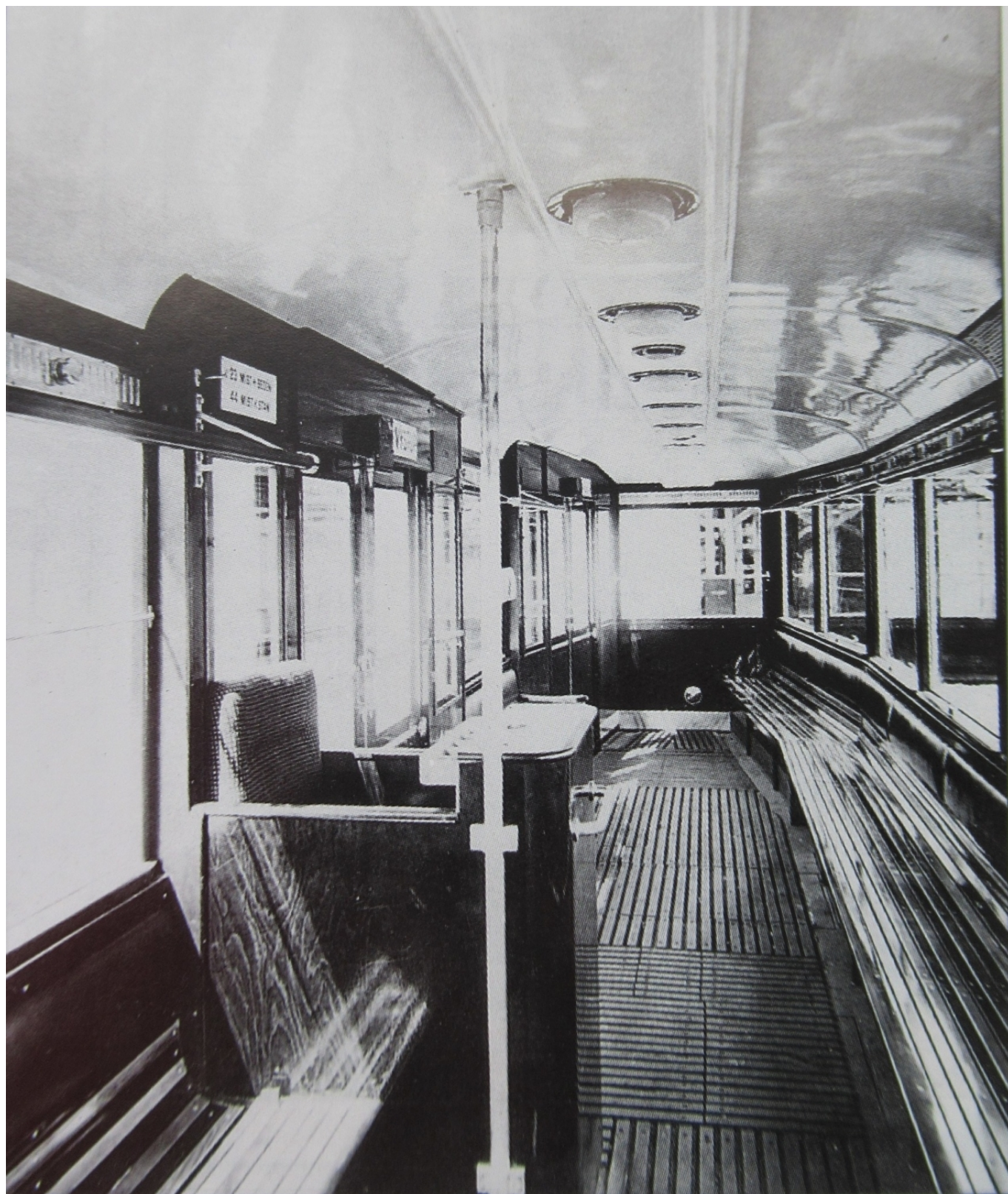
Pohled do interiéru vozu „mevro“ s kabinou průvodčího. (zdroj: Archiv VÚKV)
