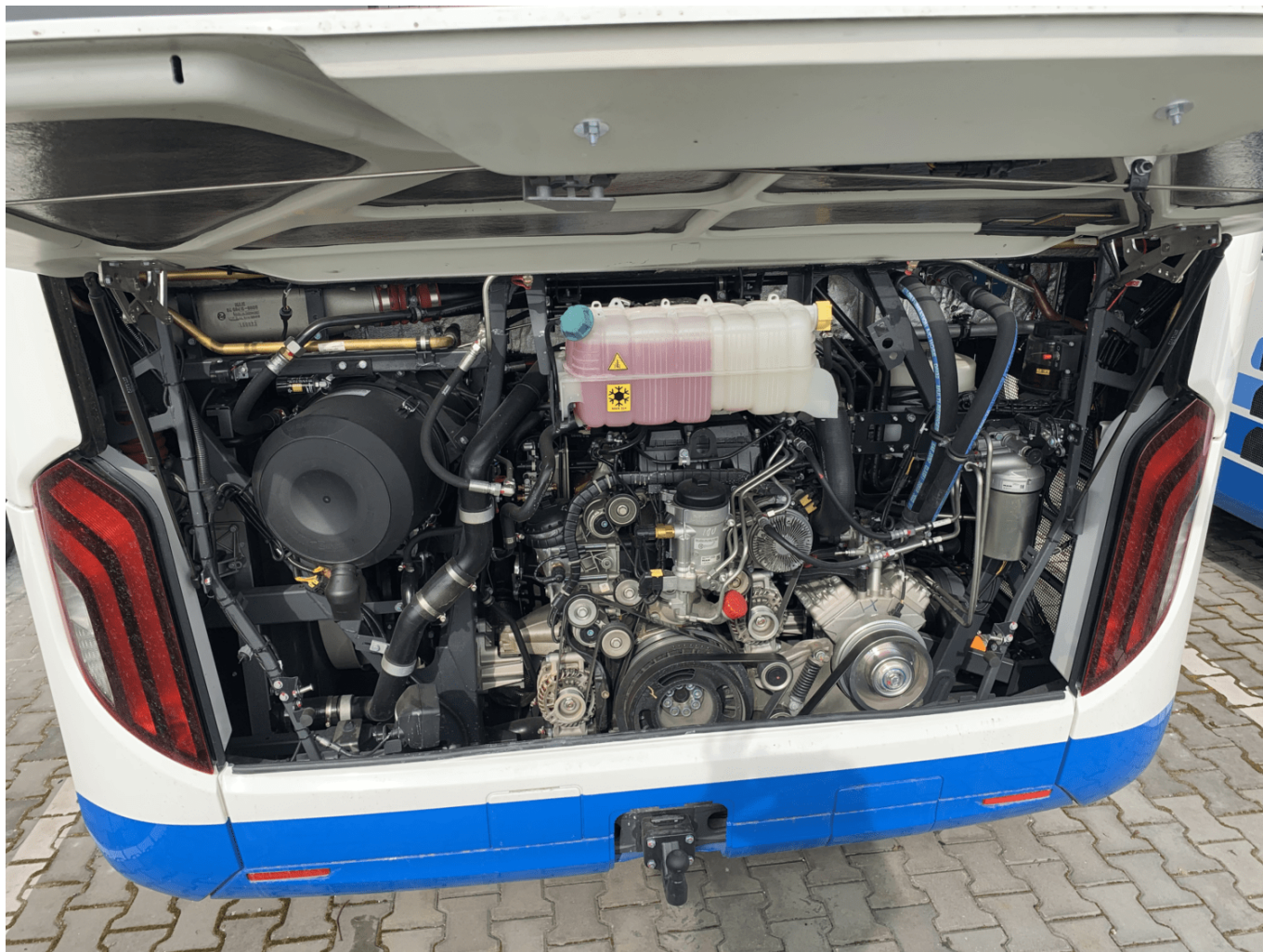
Pohon zajišťuje diesellový motor o výkonu 265 kW. (foto: MAN Truck & Bus)
