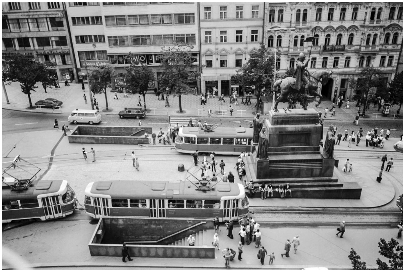
Tramvaje T3 na Václavském náměstí. Z tramvajové zastávky byl zajištěn přímý vstup do metra, nejprve od roku 1974 na trasu C, posléze v letech 1978 až 1980 na trasy C a A. (zdroj: archiv DPP)
