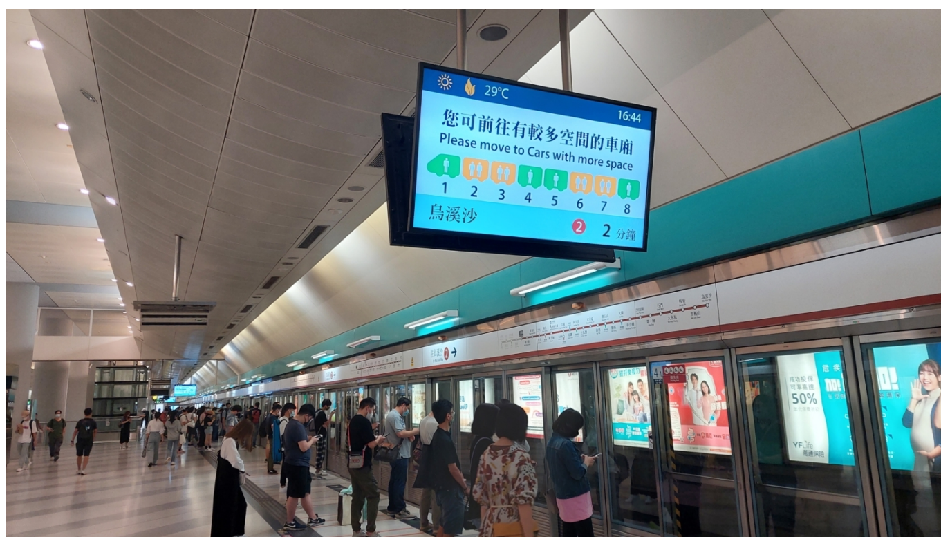
Displej ve stanici Yuen Long informující cestující mj. o obsazenosti následující soupravy. (foto: Lukáš Vrána)
