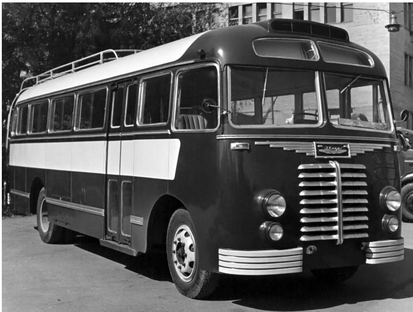
Autobus Ikarus 30 v méně tradičním provedení bez typických okének v oblině střechy. (zdroj: Wikipedia.org)
