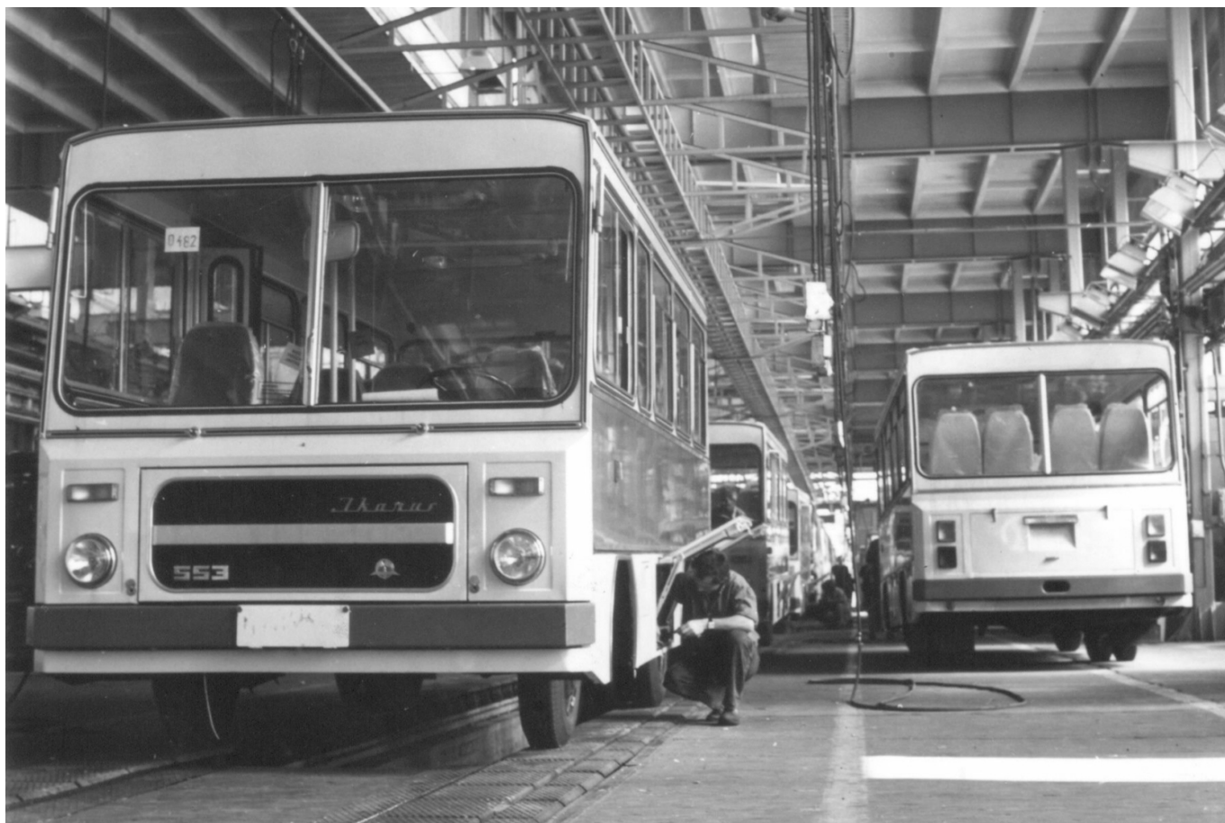
Výroba autobusů Ikarus Avia 553 v Maďarsku. (foto: Ikarus)
