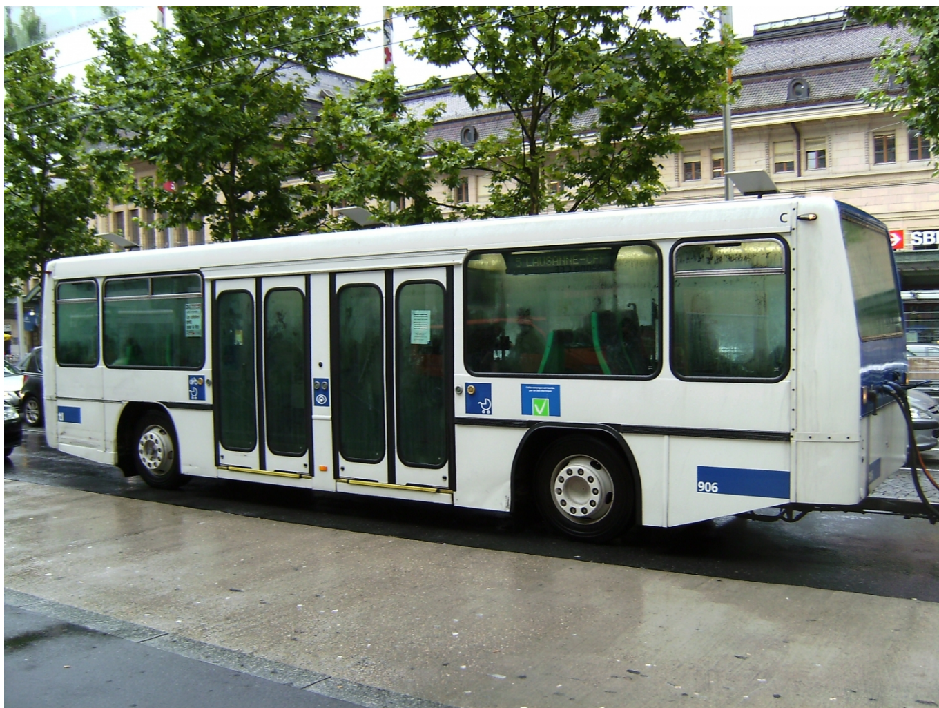
Nízkopodlažní trolejbusový přívěs HESS/Lanz+Marti v Lausanne. (zdroj: Wikipedia.org; foto: Vitaly Volkov)
