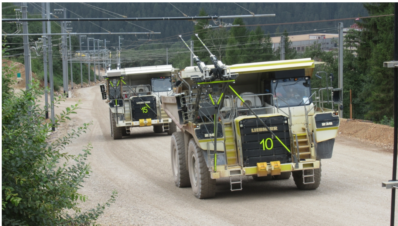
Napětí v síti činí pro městské trolejbusy neobvyklých 900 V DC. (foto: VA Erzberg GmbH)
