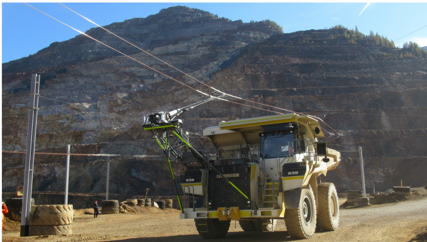
Výška trolejového vedení činí 7 m a vzdálenost mezi vodiči 70 cm. (foto: VA Erzberg GmbH)
