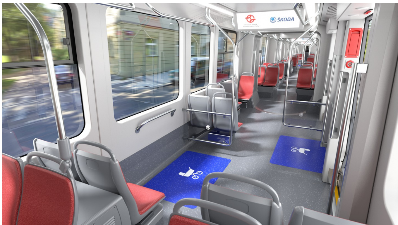
Pohled tramvaje Škoda 52T - prostor pro vozíčkáře a dětské kočárky. (zdroj: Škoda Transportation)
