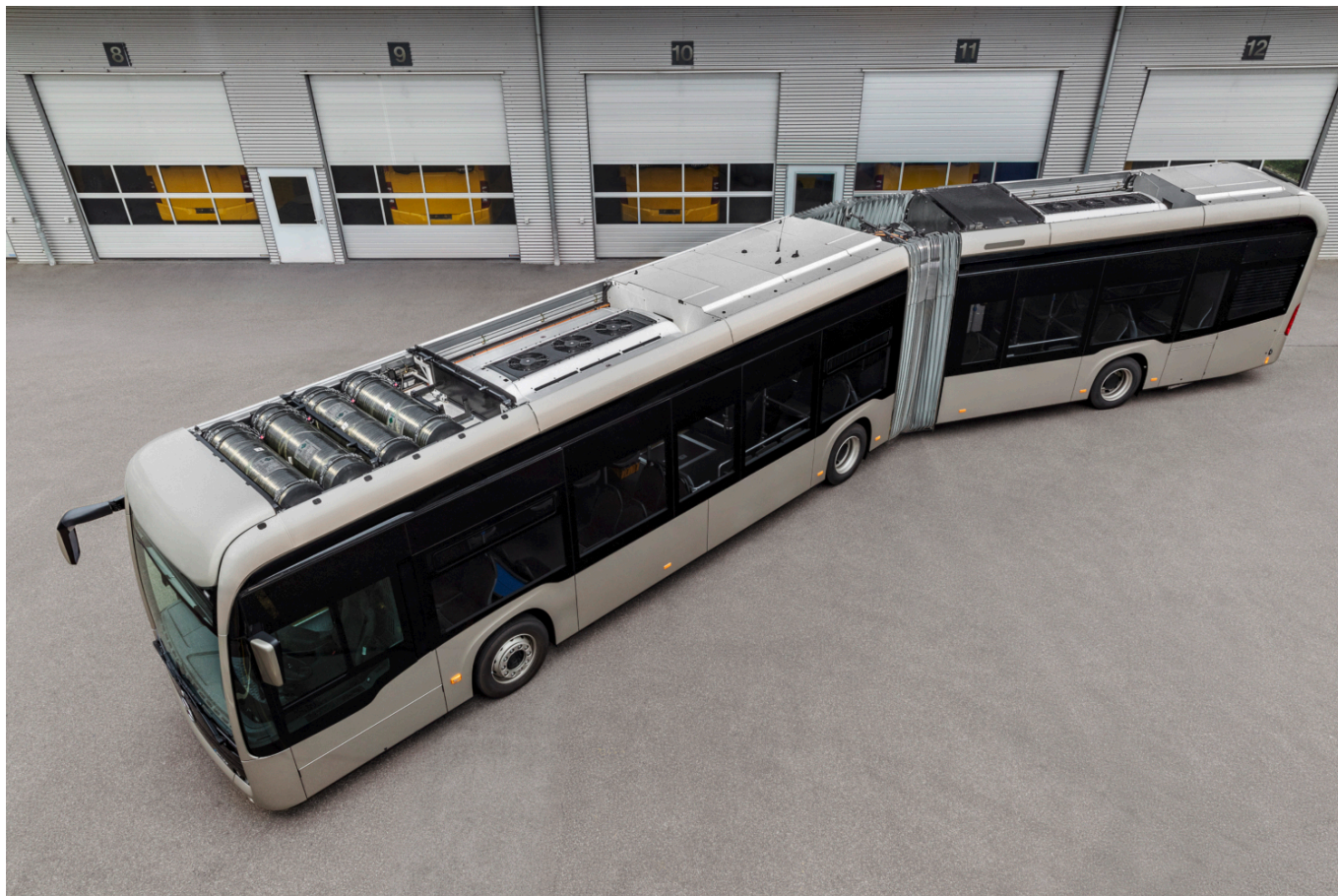
Pohled na střechu Citara REX v článkovém provedení s dobře patrnými nádržemi na vodík. (foto: Daimler Buses)
