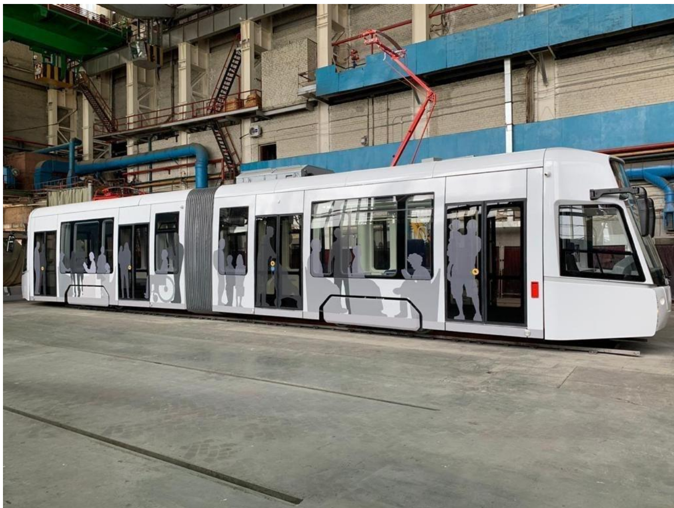
Prototyp 71-142 je obousměrný, má ostatně dveře na obou stranách i dva sběrače, zůstal ovšem bez zákazníka. (foto: Instagram Sergeje Civileva )
