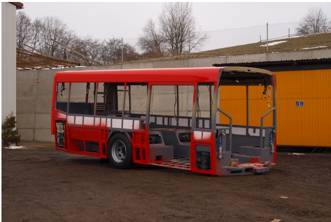
Zadní článek autobusu řady NB v kloubovém provedení během výroby.
