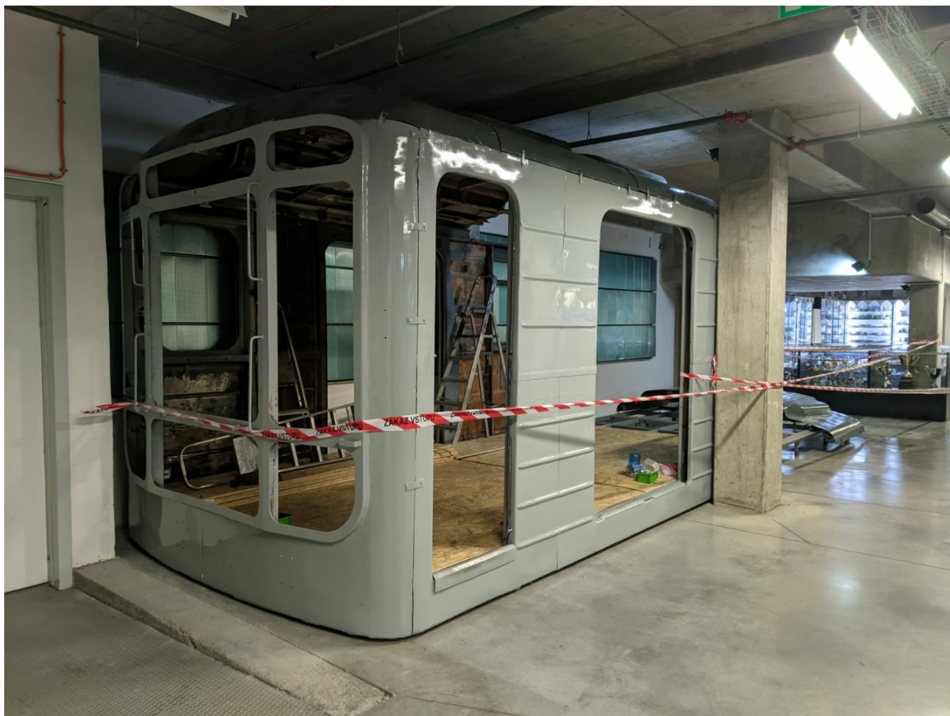
Nalakovaný a částečně složený skelet již v areálu Království železnic. (foto: Kryštof Šenkýř)
