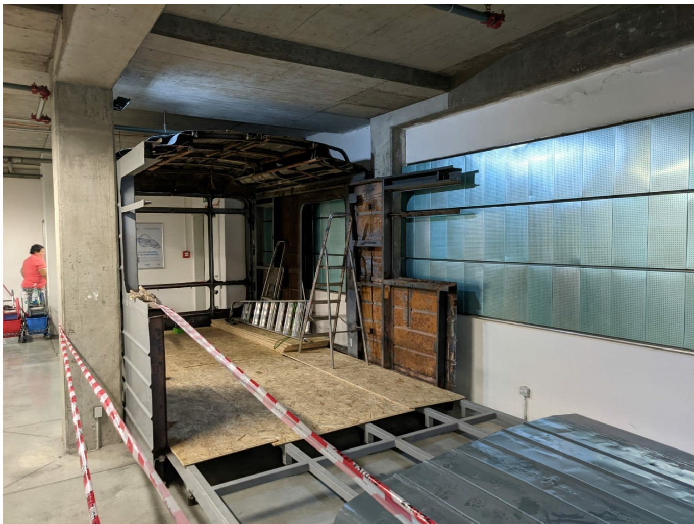
Simulátor metra 81-71 se skládal na místě z částí velkých zhruba 2 x 1,5 m. (foto: Kryštof Šenkýř)
