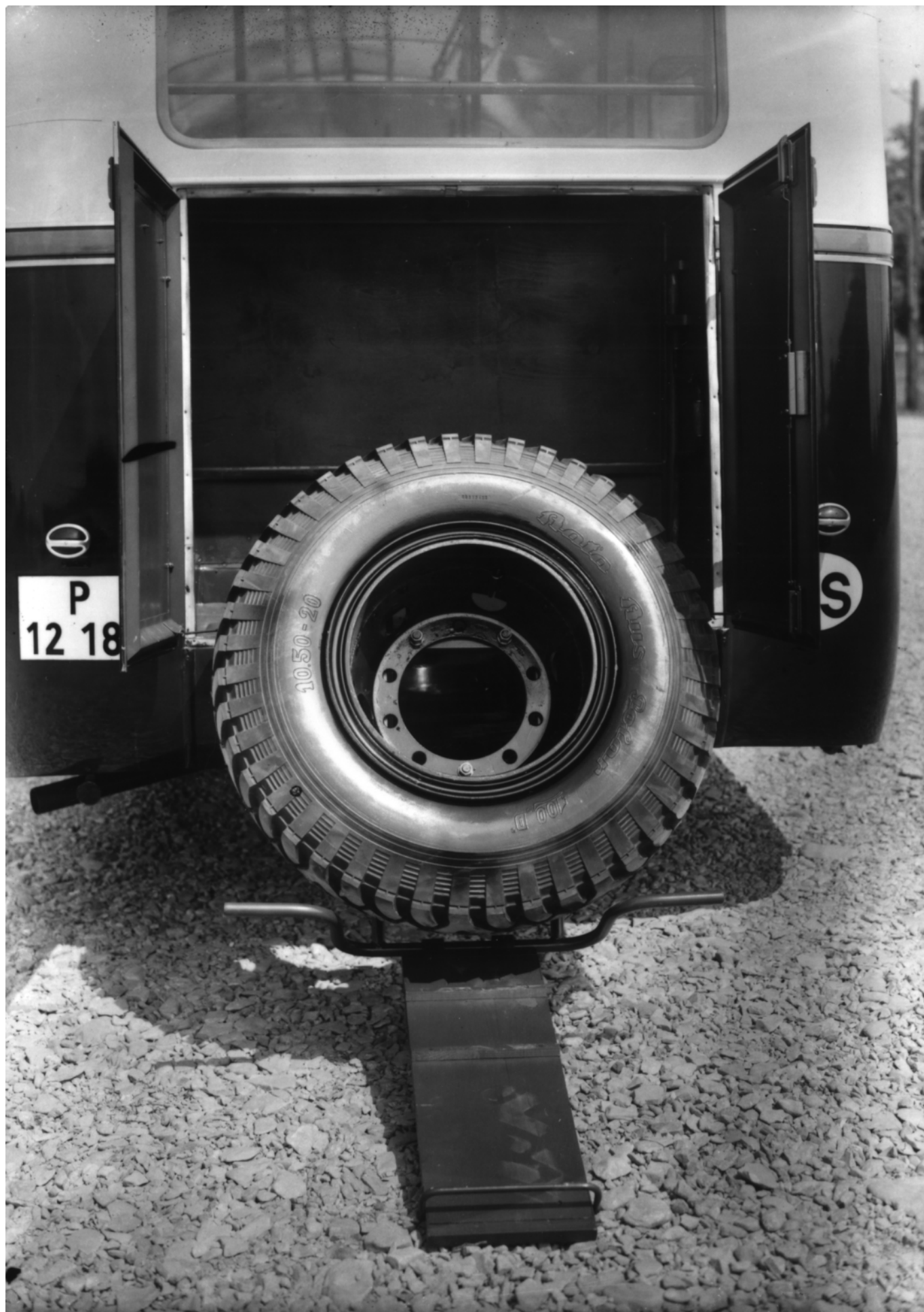
Uložení rezervy ve schráně na zadním čele u pražského vozu Praga NDO. (sbírka:
