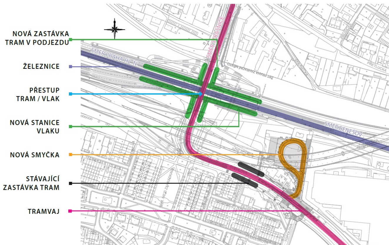
Názorné schéma uspořádání budoucí tramvajové smyčky.
