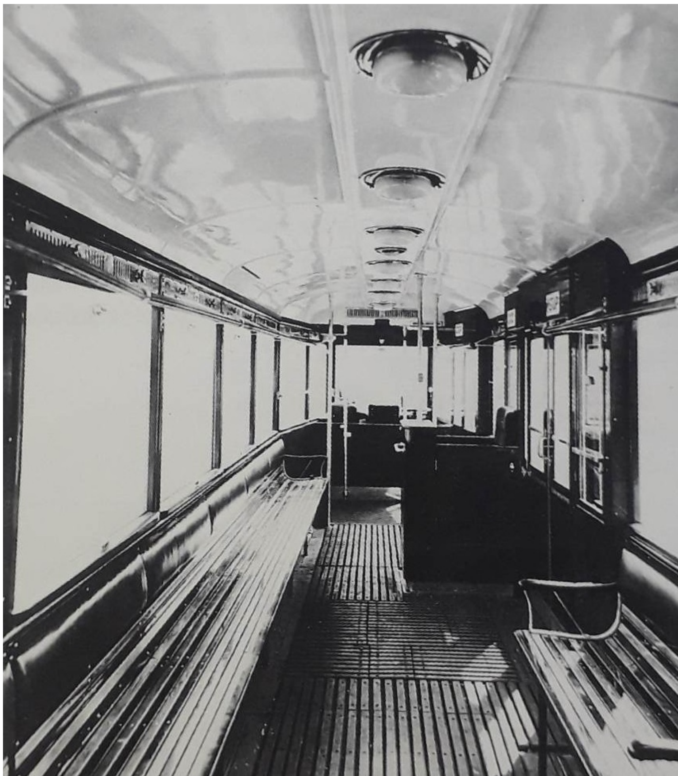
Pohled do interiéru vozu mevro ve stavu po dodání. Ze snímku je dobře patrné pracoviště průvodčího. (foto: archiv DPP)
