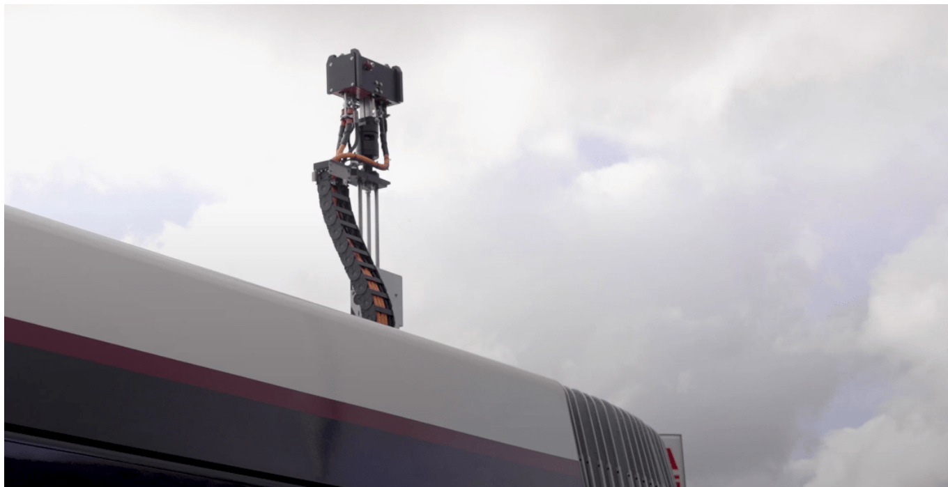
Výsuvné nabíjecí rameno elektrobuse. (zdroj: město Clermont-Ferrand)
