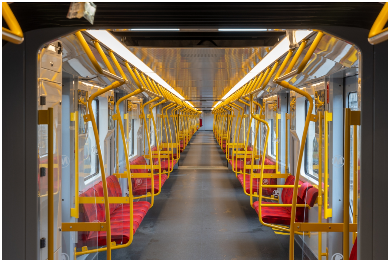
Průhled interiérem soupravy, která je řešena jako plně průchozí. (foto: Škoda Transportation)
