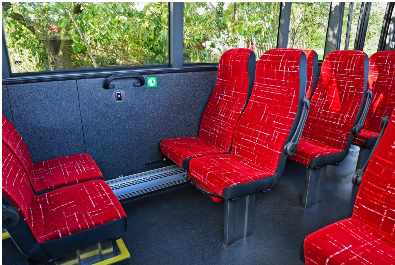
Sedačky přístupné z úrovně nízké podlahy. (foto: Miroslav Halász)
