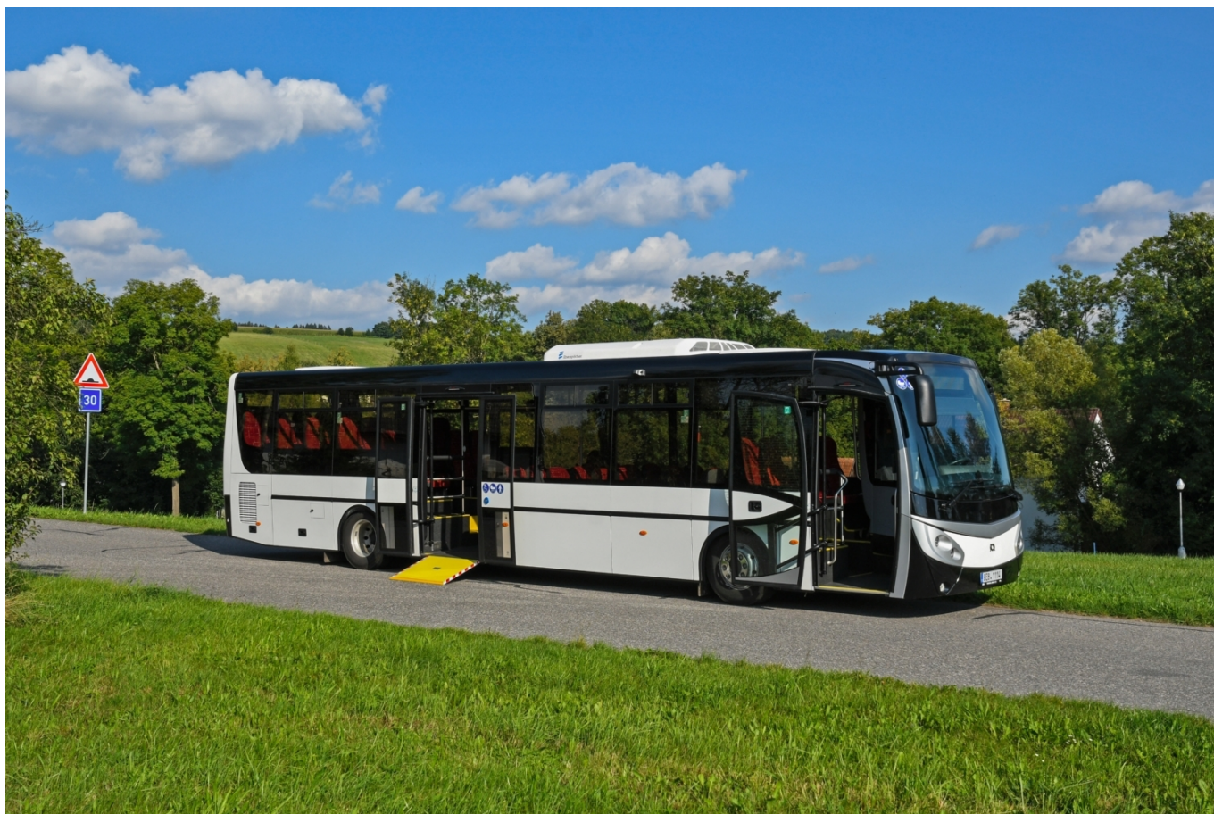
Autobus SOR ICN 12 s vyklonenou plošinou pro vozíčkáře. (foto: Miroslav Halász)
