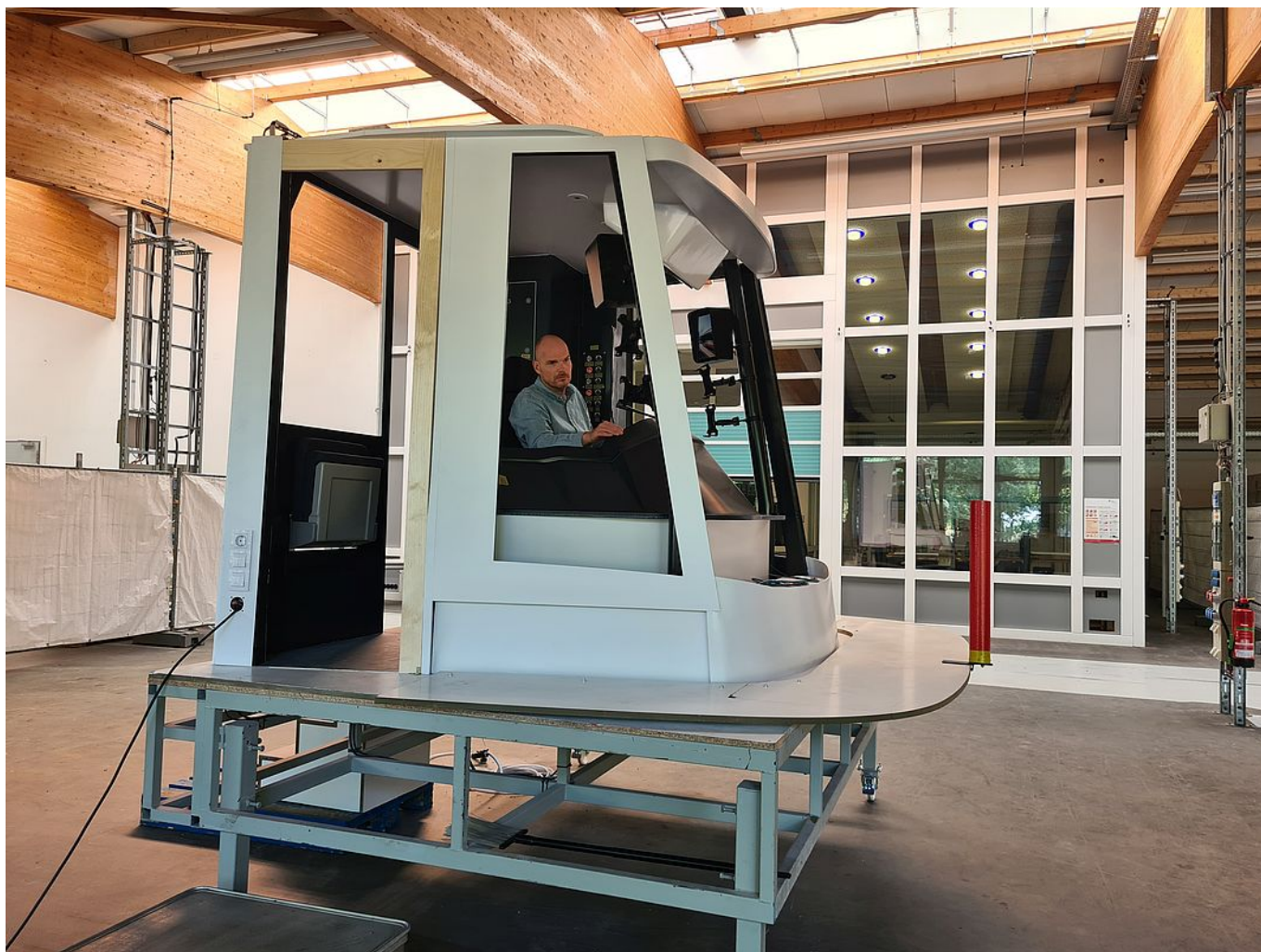
První část mock-upu v podobě nedokončeného čela tramvaje na snímku ze srpna 2022. (foto: KVV)
