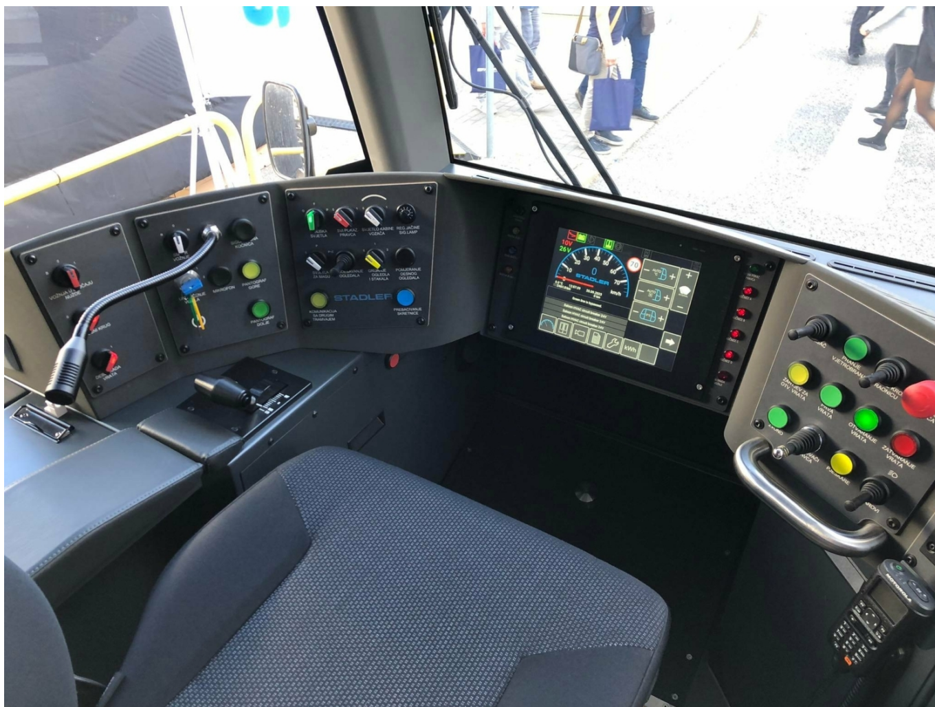
Pohled na stanoviště řidiče tramvaje Stadler Tango NF3 Sarajevo.(foto: Witold Urbanowicz; Transport-Publiczny.pl)
