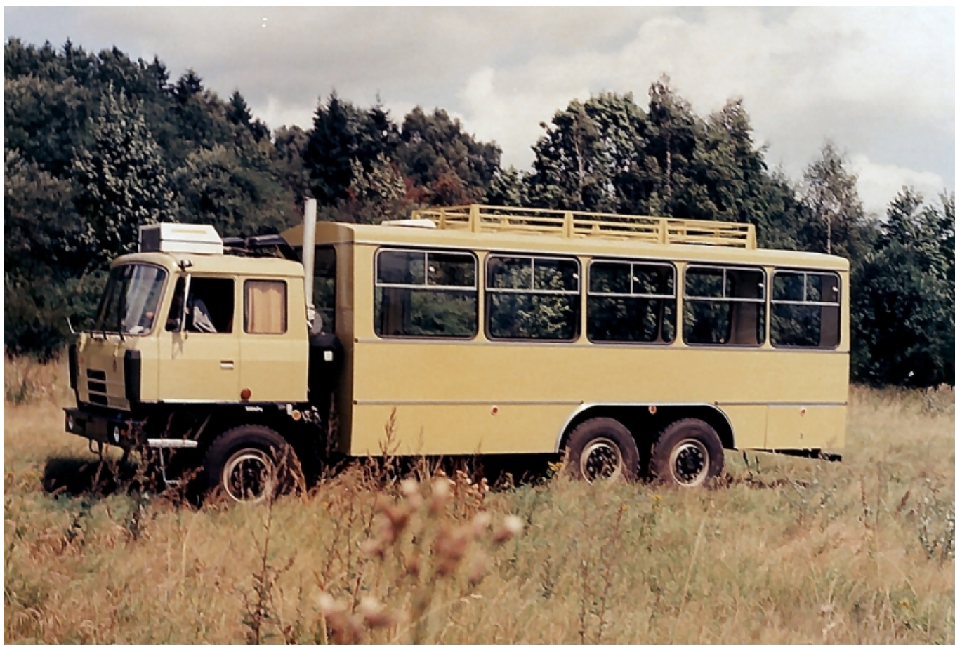
Pohled zleva na Tatrabus se skříňovou nástavbou s prvky z trolejbusu Škoda 14 Tr. (sbírka: Jan Neumann)
