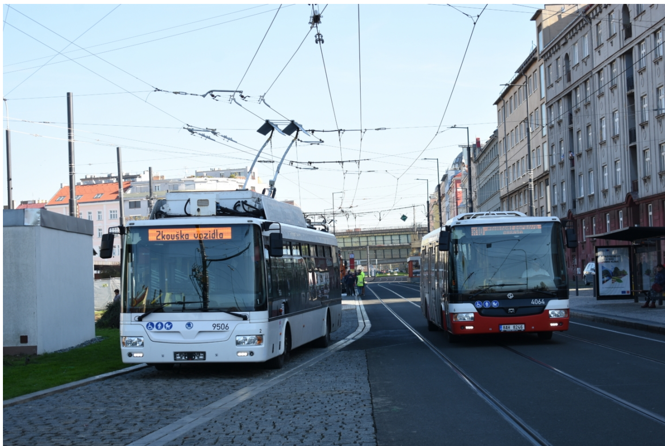
Zkouška nabíjecí stopy na Palmovce dne 27. 10. 2022. Právě zde se nachází i trojice sjezdových výhybek.(foto: Libor Hinčica)
