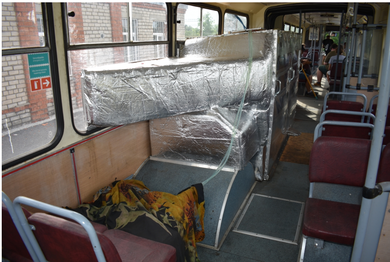
Ještě jeden pohled na řešení diesellového agregátu v interiéru vozu. (foto: Libor Hinčica)
