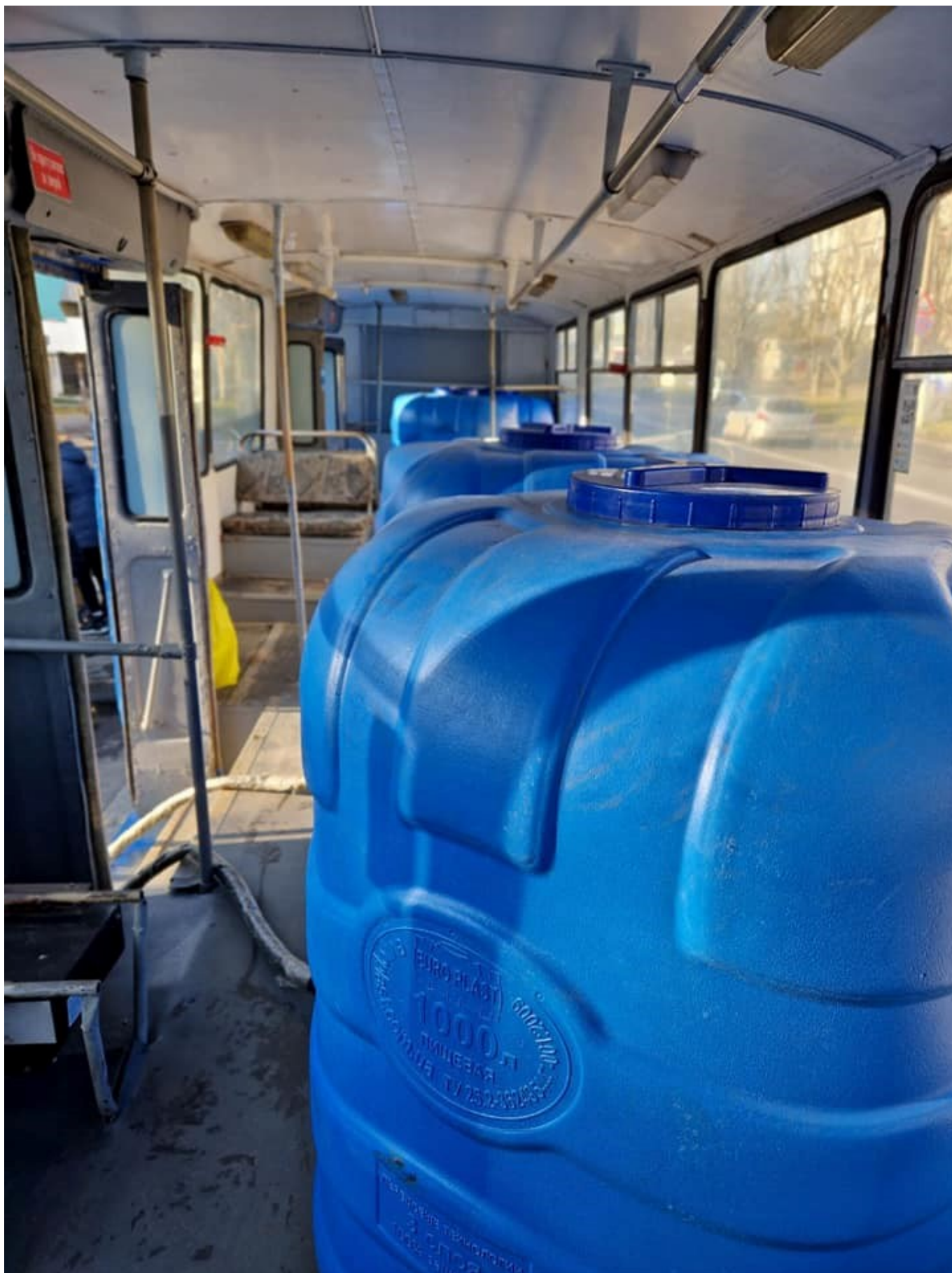
Pohled na interiér trolejbusu ZiU-682V, do kterého se pracovníkům vozovny podařilo umístit 4 kontejnery o objemu 4 000 litrů pitné vody. (foto: КП ММР „Миколаївелектротранс“; 10. 11. 2022)
