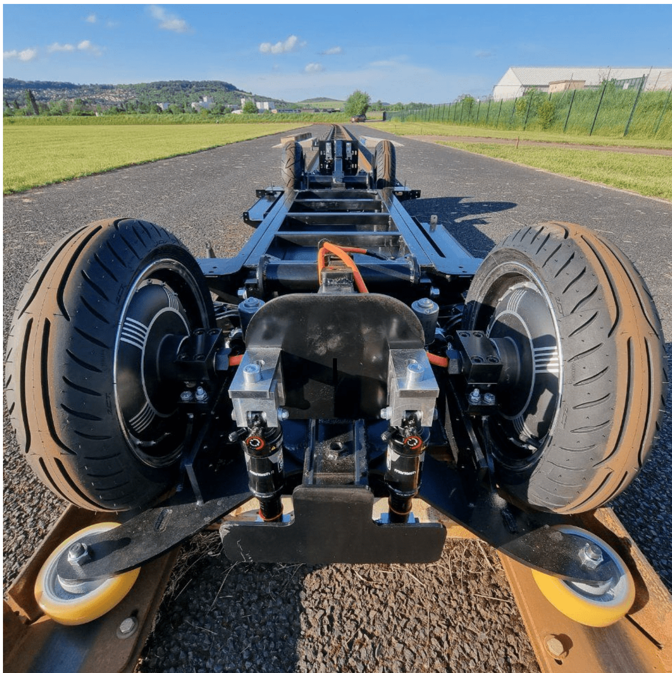
Pohled na podvozek Urbanloopu s vodicími kolečky. (zdroj: Urbanloop)
