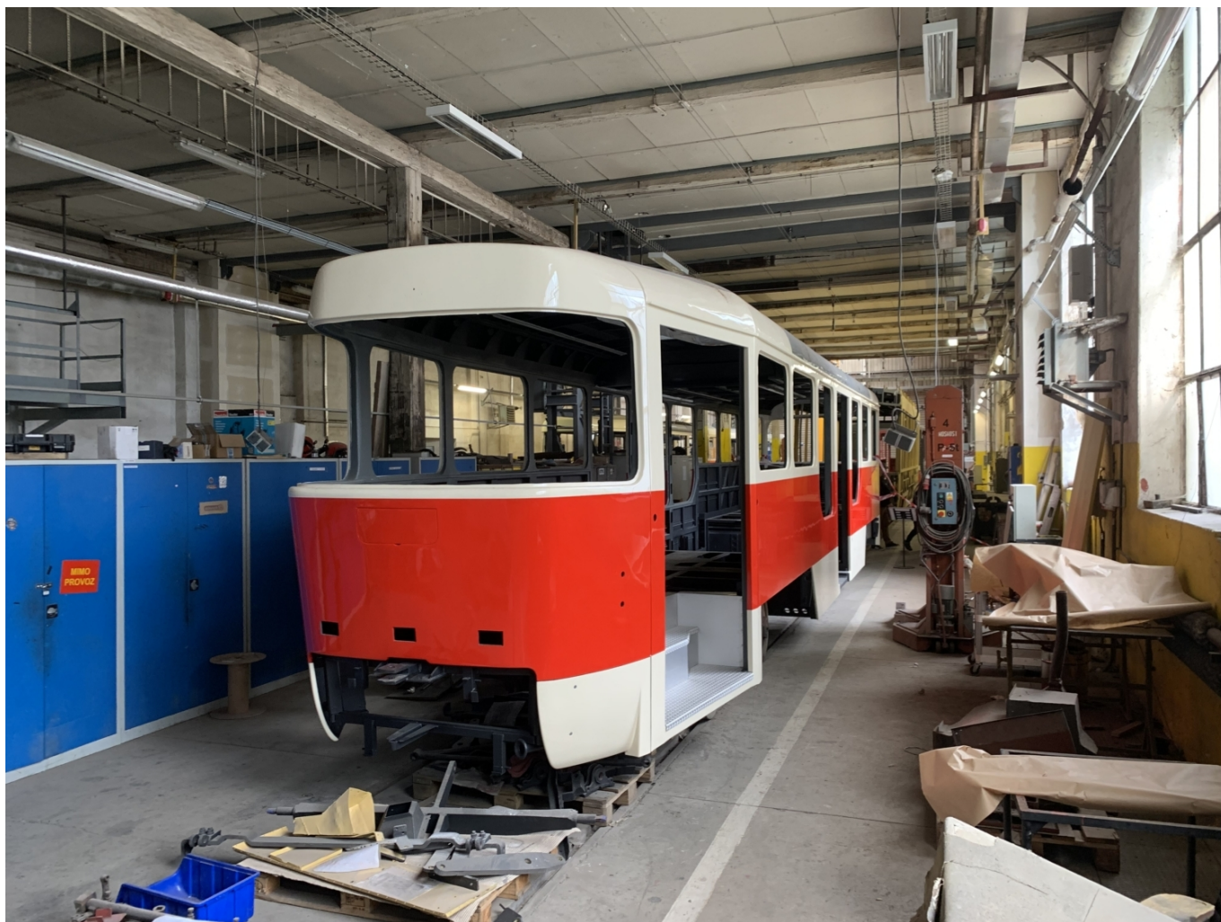
Jedna z rozpracovaných skříní tramvají T3R.PLF pro pražský DP v Krnovských opravnách a strojárnách v září 2022. (foto: Libor Hinčica)
