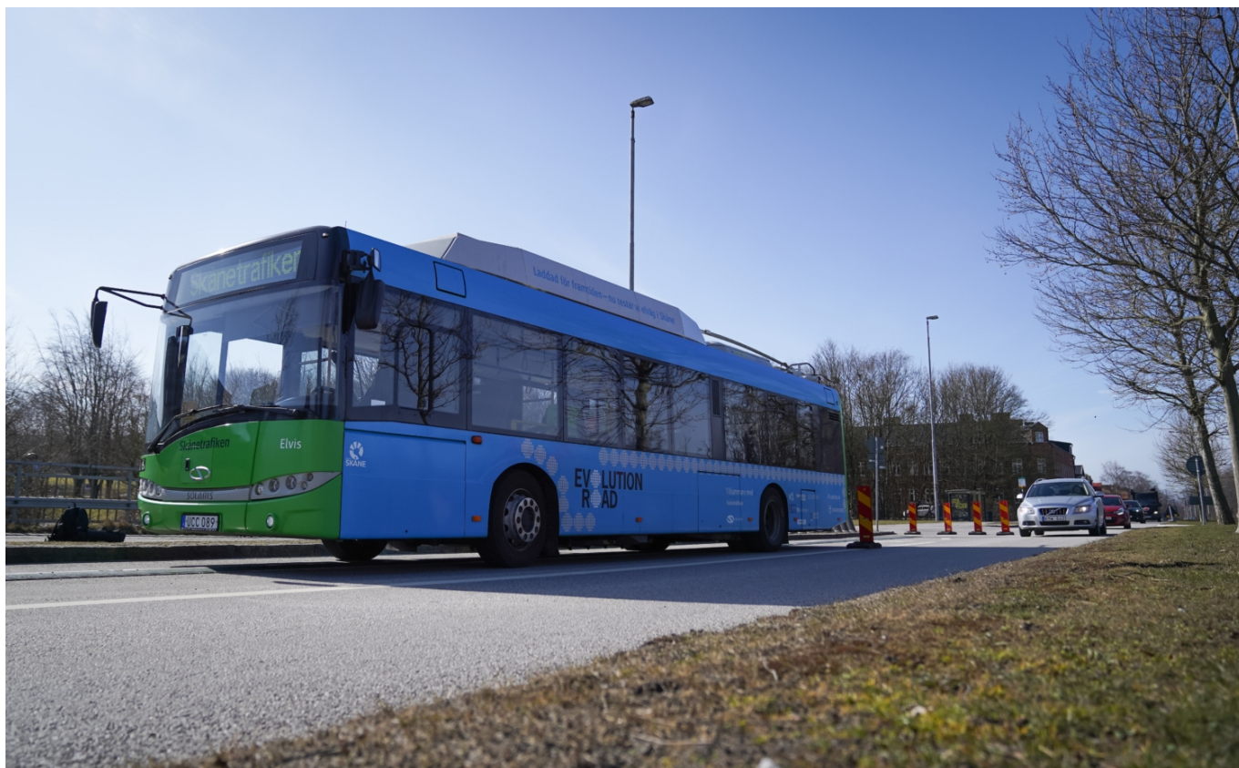
Trolejbus Solaris Trollino 12 upravený pro spodní přívod proudu. (foto: EVolution Road)
