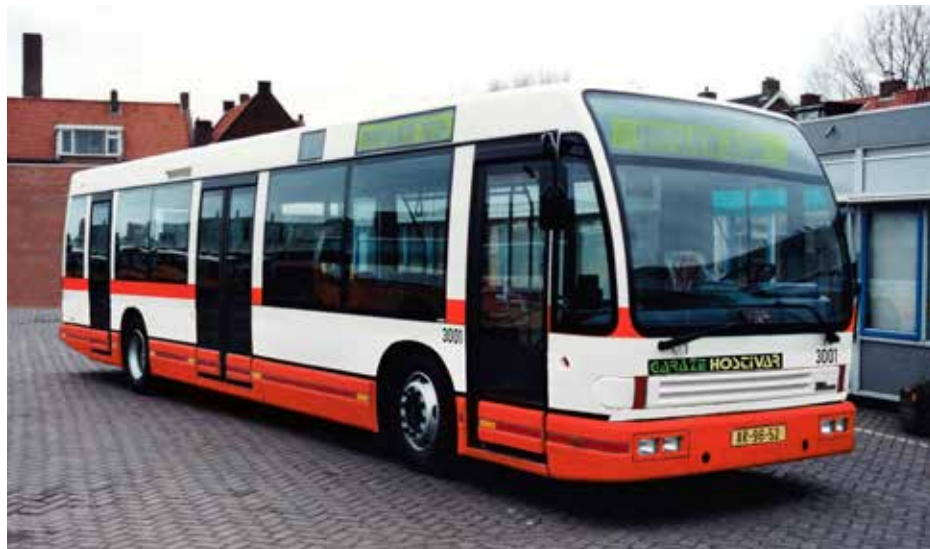
Tato fotomontáž odpovídá provedení, které bylo popsáno v rámci specifikace z podzimu 1992. Podle ní měly být v Praze vyráběny třídvéřové vozy, jež by měly první a poslední dveře pouze jednodveřilí. Foto: Wijnand Keesmaat, grafická úprava: Honza Tran
