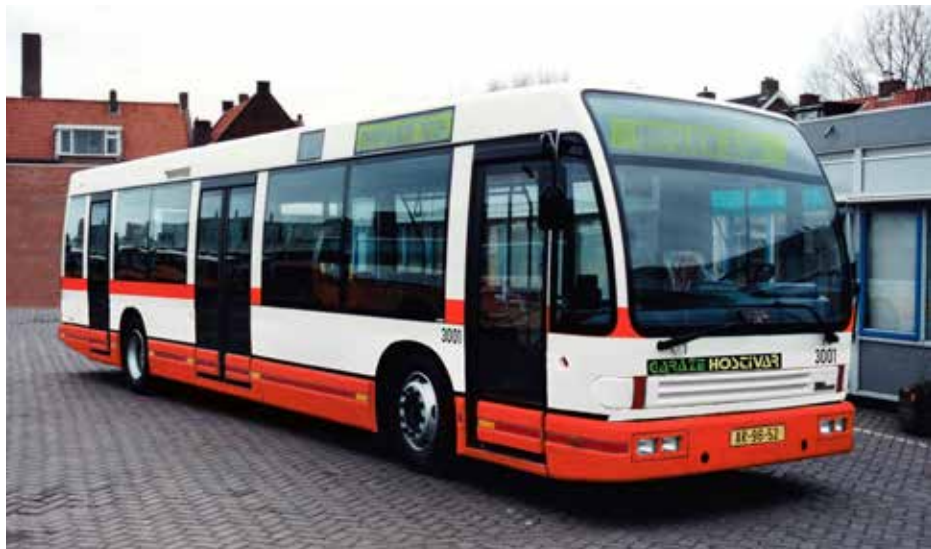
Tato fotomontáž odpovídá provedení, které bylo popsáno v rámci specifikace z podzimu 1992. Podle ní měly být v Praze vyráběny třídvéřové vozy, jež by měly první a poslední dveře pouze jednokřídlé. Foto: Wijnand Keesmaat, grafická úprava: Honza Tran
