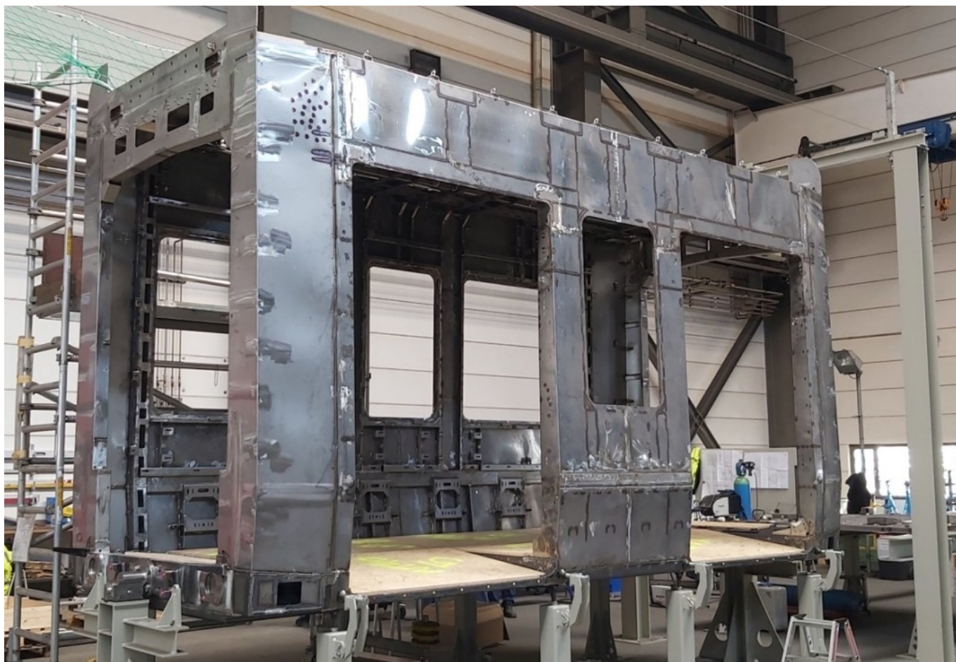
Hrubá stavba jednoho z článků nové tramvaje pro Würzburg. (foto: WSB)
