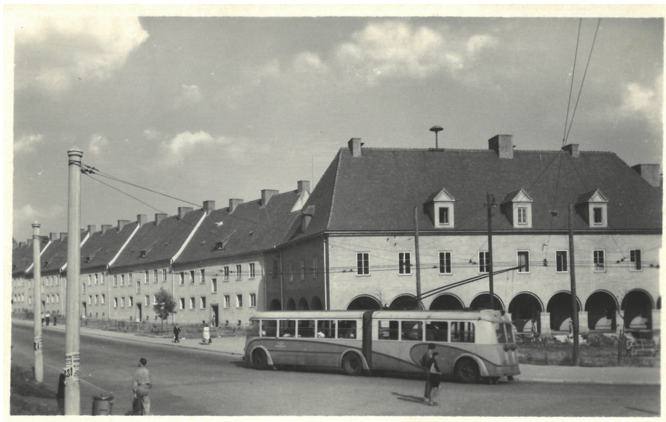
Jedna ze známých poválečných pohlednic; vyobrazující italský trolejbus STANGA/Isotta/TIBB ze série vozů ev. č. 101 až 104 v Litvínově. (sbírka: Libor Hinčica)
